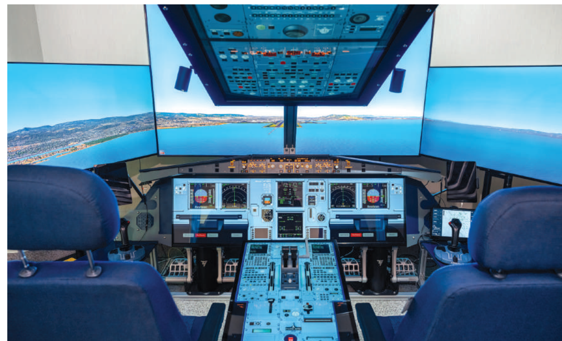
飞行模拟器 1:1 模拟驾驶舱内设有主仪表版、飞行控制组件 (FCU)，以及多用途控制及显示组件 (MCDU)
